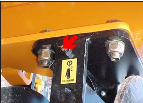
Fig. 5.08: DD Roll Grease Points
