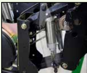
sistema Row-Pro® de presión neumática al piso por cada tren de siembra
