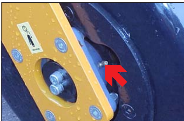
Fig. 5.08: DD Light Roll Grease Points
