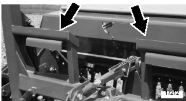
Рисунок 3-1 Специальные скобы для дополнительного веса
